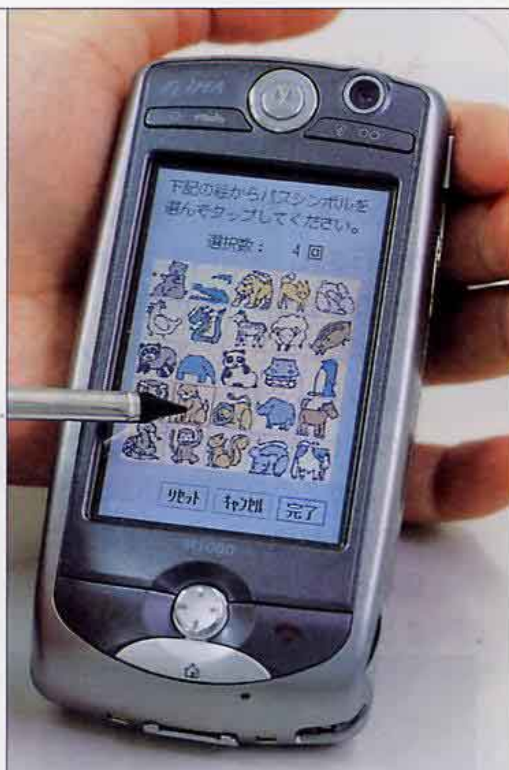
電話機能付き携帯情報端末に搭載されている、ニーモニックガードのパスシンボル選択の画面。まず携帯情報端末の電源を入れ、画面の2カ所をペンで触れるとこの画面が現れる。その後、あらかじめ本人が登録している写真やイラストなどのパスシンボルを、登録している順番通りにペンで触れると本人認証がなされ、次の画面に移動できる仕組みだ。
